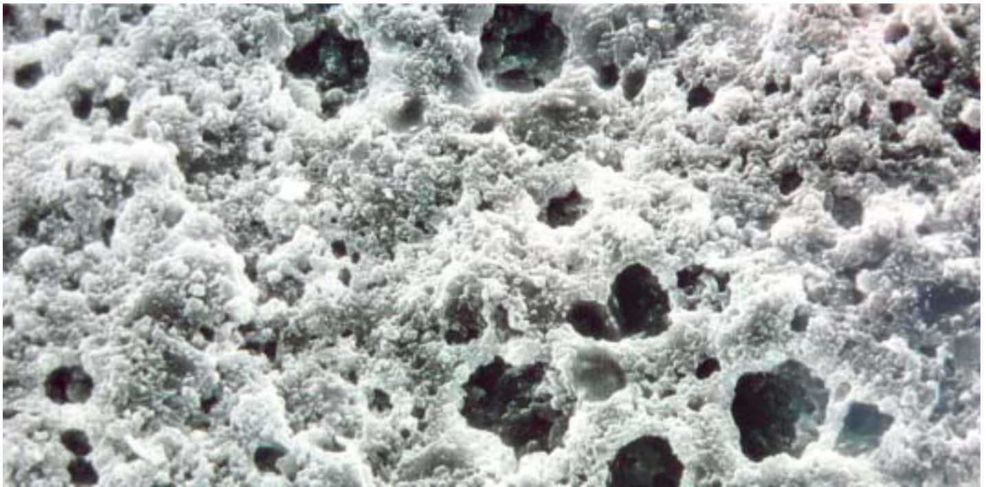
Микропористая структура покрытия, выполненного краской AmphiSilan (масштаб 1:1000)
